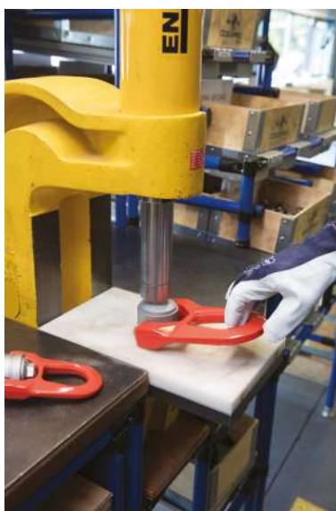
Montaje de un cáncamo DSR
